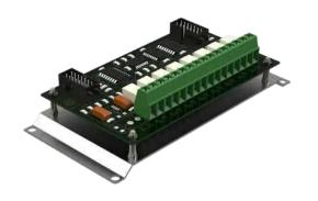
Tarjeta de expansión de 8 relés con funcionamiento NC para tarjetas DEA Security que prevean la utilización. Las funciones de cada relé están determinadas por la tarjeta principal.
