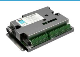
Tarjeta electrónica para la gestión centralizada de las tarjetas de interfaz SC-SMCA-PU. Elabora simultáneamente las señales que llegan desde todas las SC-SMCA-PU a ella conectadas (hasta 24), discriminando las señales típicas de una intrusión de otras generadas por perturbaciones ambientales.
