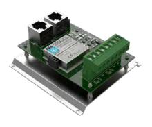
Tarjeta de interfaz para un módulo-sensores SISMA CA que amplifica las señales que llegan desde el módulo-sensores y los transmite a la unidad SC-SMCA-CTRL tramite la red de comunicación SMCA NET.
