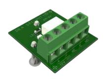
Tarjeta de expansión de 1 relé para la conversión de una salida OC en contactos C/NC/NO.
