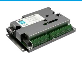
Interfaz de alimentación periférica que permite alcanzar la máxima extensión (800 metros) de la red SMCA NET con el máximo numero de unidades SC-SMCA-PU conectadas (24). SC-SMCA-AS necesita una fuente de alimentación local de 12 V, estabilizada y líneal, con capacidad de por lo menos 1,5 A.
