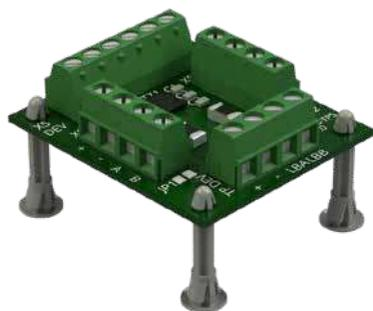
Tarjeta periférica de interfaz para la conexión de dispositivos de terceras partes con el Bus XENSITY. Esta tarjeta, compatible exclusivamente con el controlador BR-XS-CTRL32, puede alimentar el dispositivo que a ella se conecta y enviar las relativas señales al sistema XENSITY. No necesita de una fuente de alimentación local.
