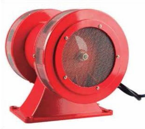
Sirena motorizada con un diámetro externo de 80/100 mm que produce una salida de 40 W de volumen de sonido. Adecuado para información de advertencia de polipastos pequeños, vagones de transferencia ligeros y el interior de embarcaciones pequeñas. Color estándar: ROJO; Material de la carcasa: aluminio y acero; Impedancia de aislamiento: 100M omega (a 500 VCD); Resistencia de voltaje: 500 VAC, 50 / 60Hz en 1 minuto; Grado de protección: IP44
