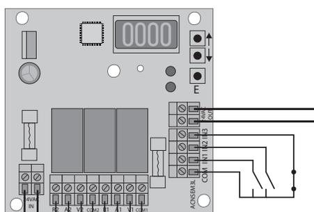
Fuente de alimentación auxiliar para 24Vac/dc, máximo 0.5A.
