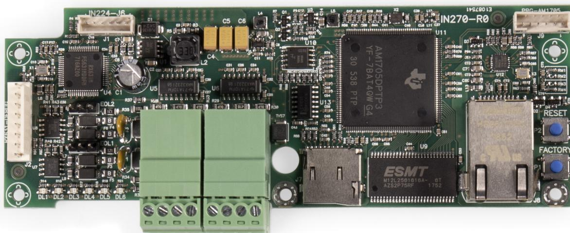
Además de las funciones descritas para el módulo PREVIDIA-C-COM (2 puertos RS232 y 2 puertos RS485), el módulo PREVIDIA-C-COM-LAN ofrece una toma para la conexión a la red Ethernet, mediante la cual (teniendo conectadas a la misma red tanto la tarjeta madre como el módulo) se implementan las siguientes funciones TCP-IP APN avanzadas.
