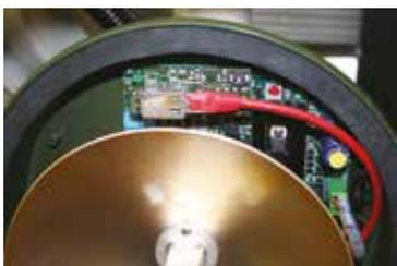
IP-Doorway permite que todos los detectores digitales de CIAS sean compatibles con IP. Mediante un cable Ethernet CAT5E FTP, el producto puede ser alimentado y sus datos de alarma y configuración gestionados de forma remota.
